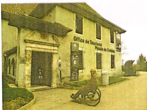
Entrée avec une petite pente à 5% sur 3.80m
